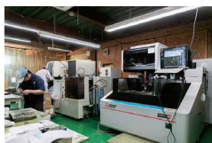
形や数量、用途に応じた最適な加工方法を提案。写真は放電ワイヤー加工機
