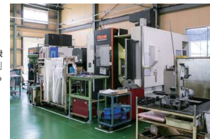
コンピュータ制御の工作機械「マシニングセンター」での切削加工も行っている
