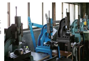
職人が手作業で部品を加工するプレス機が今も現役。手入れが行き届き、製品開発などに用いられている
